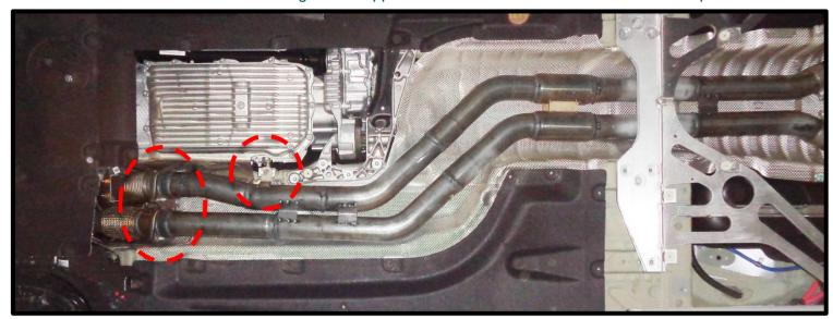
Klemm- oder Schraubverbindungen locker vorziehen. Die REMUS Abgasanlage ausrichten und die Verbindungen fest anziehen. Motor kurz anlassen und die komplette REMUS Abgasanlage auf Dichtheit überprüfen. Sämtliche Bauteile, sowohl im kalten als auch im betriebswarmen Zustand auf Funktion und genügend Freigängigkeit überprüfen. Achten Sie dabei auf einen ausreichend belüfteten Montageraum.
